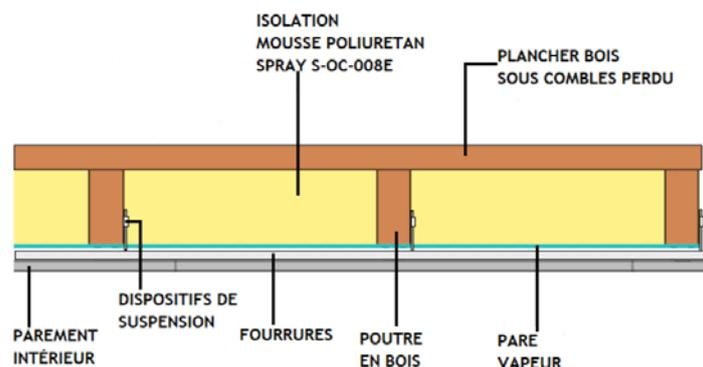
Figure 6 : Isolation sous combles perdu en planchers à ossature en bois
