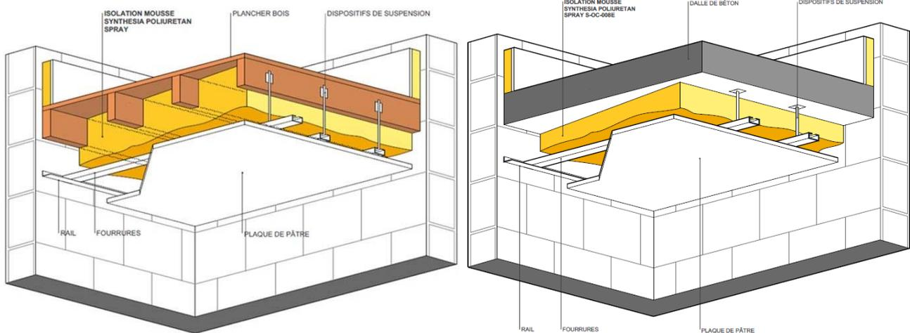
**Figures 7 : Isolation du plafond sous plancher maçonné et bois constitué de fourrures et dispositifs de suspension**
